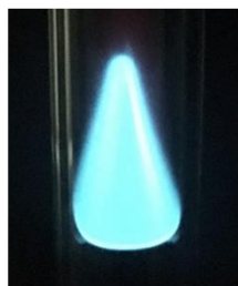
变径管内稳定 预混火焰
